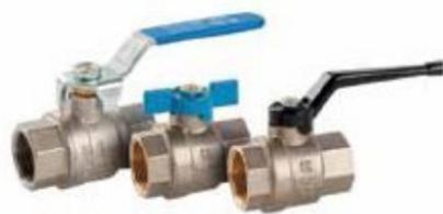
dimensioni da 1/4" a 4", hanno pressione di esercizio da 16 a 50 bar, resistenza alla temperatura da min -20°C a max 160°C. Hanno filettatura a norma ISO 228/1 e sono dotate di asta antiscoppio.
