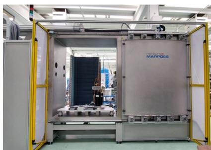
ad elevata pressione con aria secca e calibra la pressione di intervento dei pressostati di bassa e alta pressione. I test proseguono tramite prove funzionali su valvola 4 vie e prove funzionali su valvola di espansione, effettua poi la ricerca di grosse perdite mediante test di caduta di pressione nel circuito. Infine
